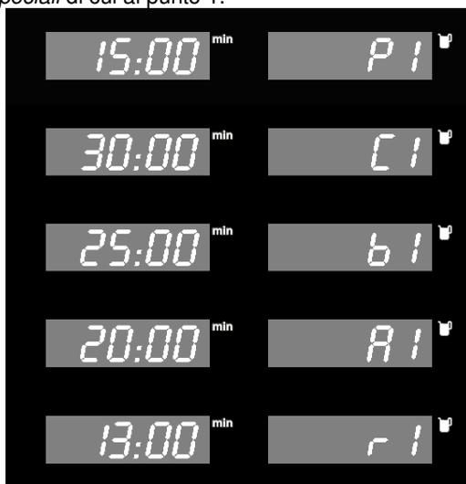
Premere PT1 per accedere alla Funzione speciale e ruotarlo per selezionare il programma, che inizia così a lampeggiare. La selezione è lineare da "X1" a "X5", "X6" o "X14", dove "X" corrisponde a "A", "B", "C",
