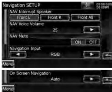
**[NAV Interrupt Speaker]** Seleziona altoparlanti per la guida vocale del sistema di navigazione. (☑ "Front All")
