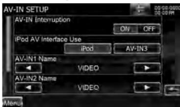
**[AV-IN Interruption]** Imposta una visualizzazione immagine del sistema collegato tramite la porta di ingresso AV. (☑ "OFF")
