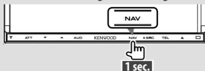
Se si tiene premuto il tasto per più di un secondo quando è visualizzata la schermata di navigazione, la funzione Picture in Picture viene attivata/disattivata.
