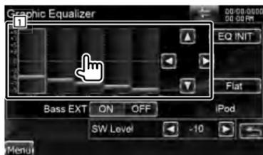
1 È possibile regolare il livello del guadagno sfiorando ciascuna barra di frequenza.
