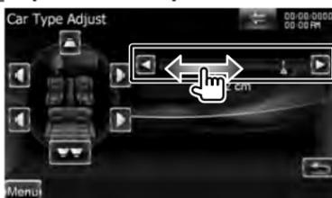
Eseguire una regolazione fine del ritardo dell'uscita dell'altoparlante specificato in <Impostare il tipo di veicolo> per un ambiente più adatto per il veicolo.
