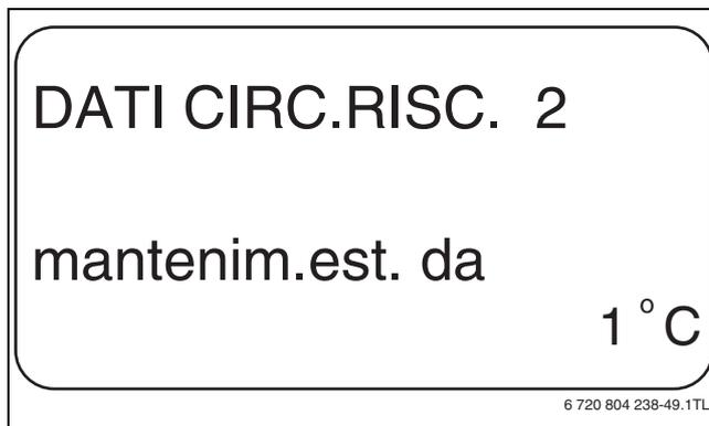
Fig. 35 Impostazione della temperatura di mantenimento esterno
