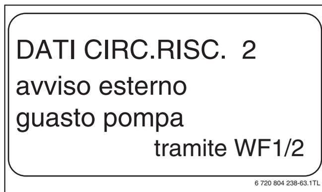
Fig. 49 Avviso esterno disfunzione pompa
