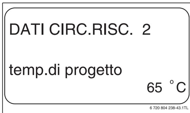
Fig. 29 Impostazione della temperatura di progetto
