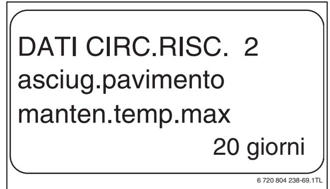
Fig. 55 Impostazione del tempo di mantenimento
