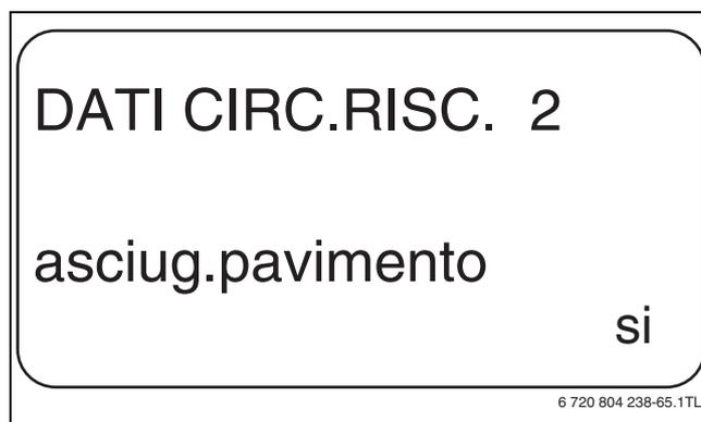
Fig. 51 Asciugatura massetto
