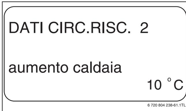
Fig. 47 Impostazione aumento caldaia
