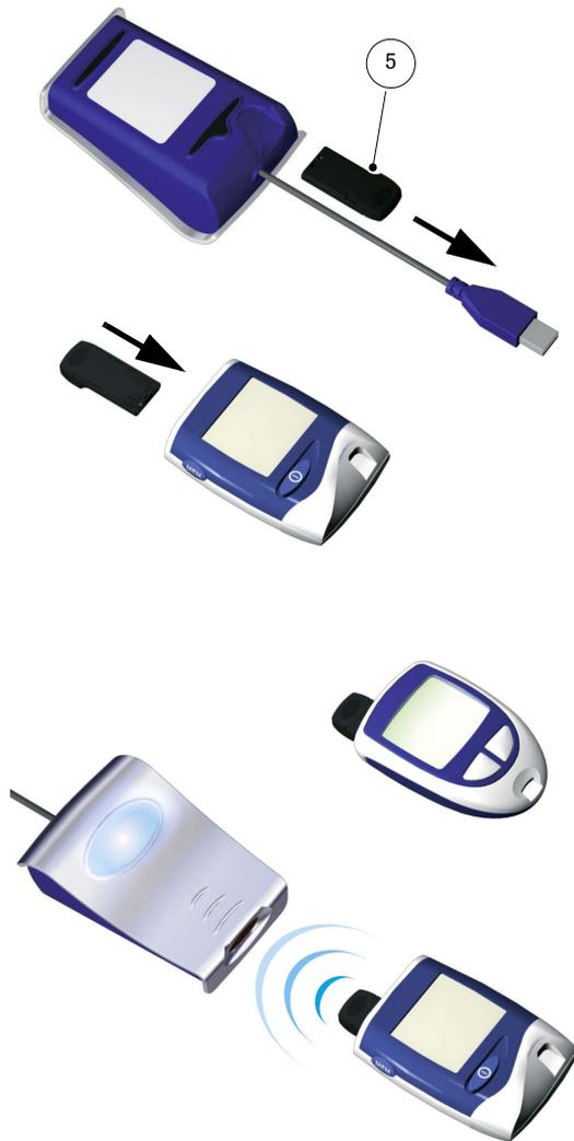
Gli strumenti di misurazione del tipo Accu-Chek Sensor/ Advantage usano, come interfaccia, i contatti con il chip codificatore per il trasferimento dei dati. Per trasferire dati da questi strumenti, procedere come segue:
