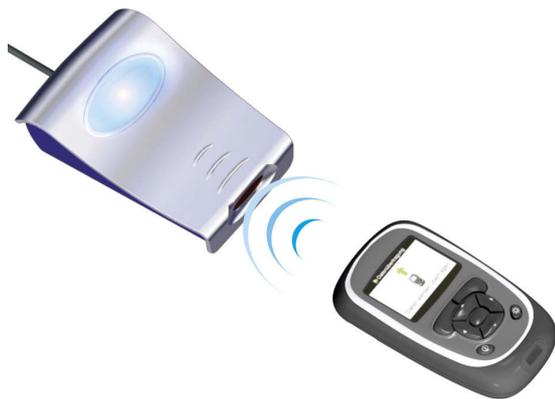
Lo strumento di misurazione Accu-Chek AvivaCombo/Aviva Expert include una porta a infrarossi per il trasferimento dei dati. Per trasferire dati da questo dispositivo, procedere come segue:
