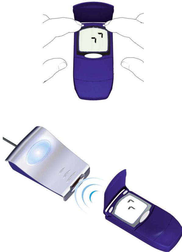
Lo strumento di misurazione Accu-Chek Compact/Integra include una porta a infrarossi per il trasferimento dei dati. Per trasferire dati da questi strumenti, procedere come segue:
