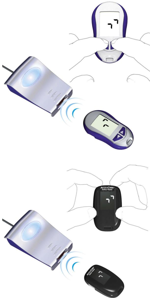
Lo strumento di misurazione Accu-Chek Aviva/Aviva Nano include una porta a infrarossi per il trasferimento dei dati. Per trasferire dati da questi strumenti, procedere come segue:
