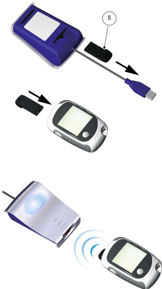
Gli strumenti di misurazione del tipo Accu-Chek Comfort usano, come interfaccia, i contatti con il chip codificatore per il trasferimento dei dati. Per trasferire dati da questi strumenti, procedere come segue:
