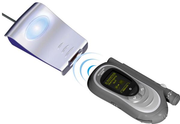
Lo strumento di misurazione Accu-Chek Mobile include una porta a infrarossi per il trasferimento dei dati. Per trasferire dati da questo dispositivo, procedere come segue:
