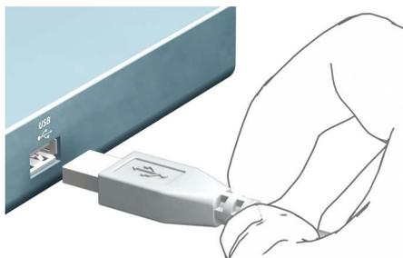
Inserire la spina USB dell'apparecchio Accu-Chek Smart Pix in una porta USB libera del computer. Ciò può essere fatto con il computer spento o acceso. L'apparecchio Accu-Chek Smart Pix riceve la corrente attraverso questa connessione e non necessita quindi né di batterie né di un cavo di alimentazione.
