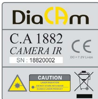
Caratteristiche del laser: Classe 2, <1 mW, lunghezza onda di 635 nm
