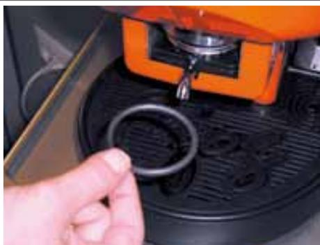
**Fig. 6.1 - C** Guarnizione prelevata
