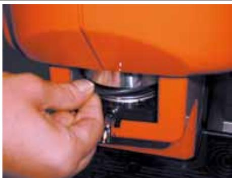
**Fig. 6.1 - D** Inserimento nuova guarnizione
