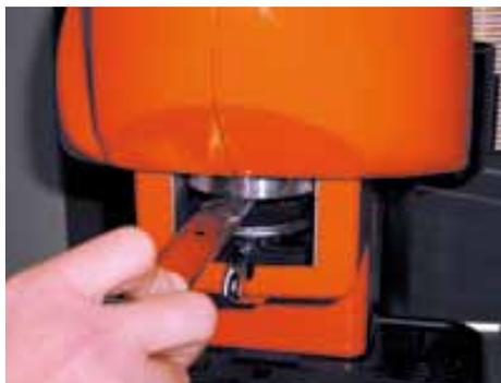
**Fig. 6.1 - A** Estrazione guarnizione
