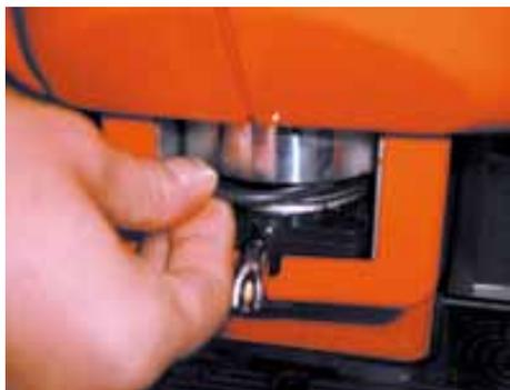
**Fig. 6.1 - B** Prelievo guarnizione
