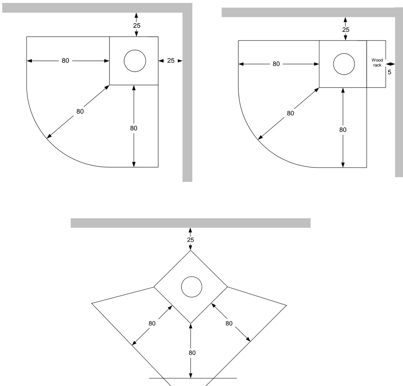
**Nota;** la stufa deve essere installata su un pavimento con capacità di carico sufficiente. Se la struttura esistente non soddisfa questo requisito, si devono adottare misure adeguate per soddisfarlo (come ad esempio, mettere una piastra di distribuzione del carico).
