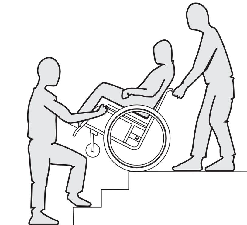
1. È possibile percorrere rampe di scale scendendo un gradino dopo l'altro, così come descritto in figura. Il primo accompagnatore si metterà dietro la carrozzina e manterrà le maniglie di spinta. Il secondo accompagnatore afferrerà una parte fissa del telaio anteriore, assicurando la posizione della carrozzina dal lato anteriore.
