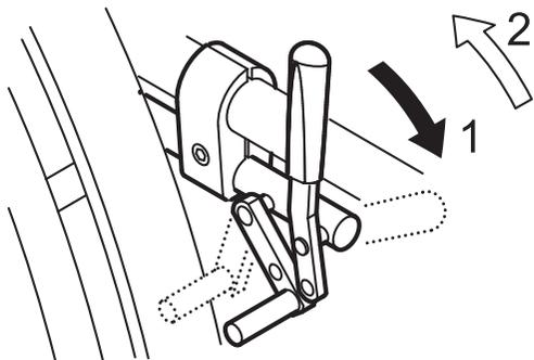
1. Per innestare il freno spingere la leva del freno in avanti fino alla battuta.
