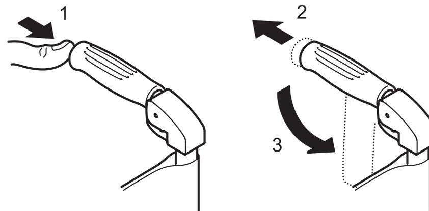
1. Per piegare verso il basso le maniglie di spinta tenere ferma la carrozzina con una mano. Prendere con l'altra mano la maniglia di spinta e azionare con il pollice il dispositivo di sgancio che si trova sotto la copertura in plastica (1).
