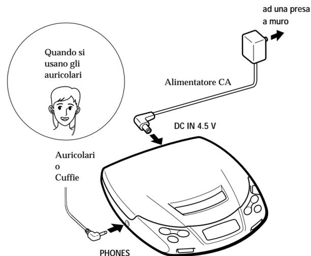
Per i modelli con l'adattatore per la spina CA in dotazione Usare l'adattatore per la spina CA se non è possibile adattare l'alimentatore CA alla presa a muro.
