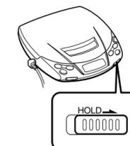
Far scorrere HOLD nella direzione della freccia. Premendo un tasto qualsiasi, nel display appare "Hol d" e non è possibile far funzionare il lettore.
