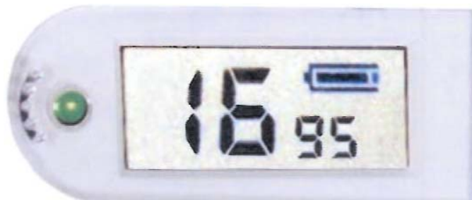
Figura 4. Immagine dello schermo LCD del TONO-PEN AVIA sul quale sono visualizzati un valore di IOP pari a 16 mmHg e un indice statistico di affidabilità pari a 95.
