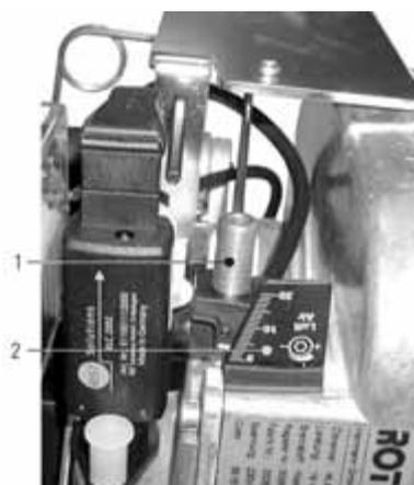
Fig. 6-6 Regolazione della fessura di ricircolo
