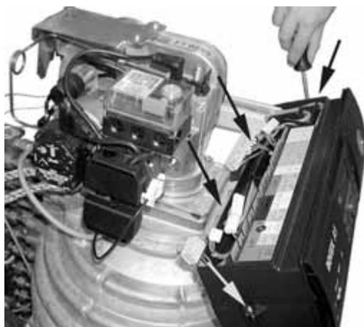
Fig. 5-16 Rimozione dei tappi a vite della copertura del quadro di comando
