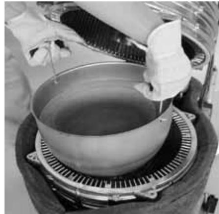
Fig. 8-13 Estrazione dell'elemento refrattario inferiore
