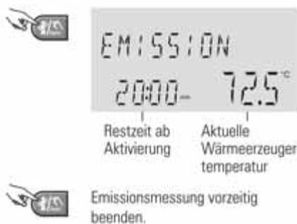
Fig. 14-2 Breve introduzione simbolica alla funzione spazzacamino della regolazione ROTEX THETA 23R
