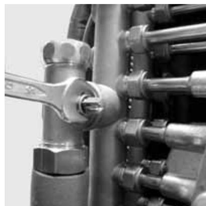
Fig. 5-13 Svitare ed estrarre la sonda di temperatura di mandata
