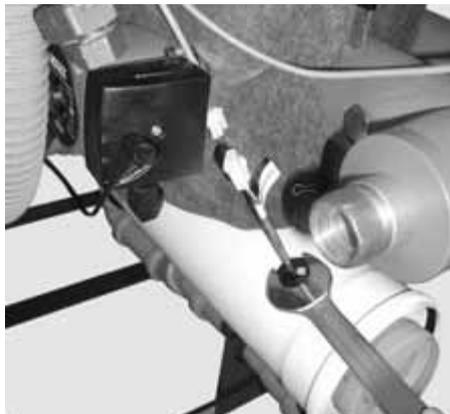
Fig. 5-15 Svitare ed estrarre la sonda di temperatura fumi
