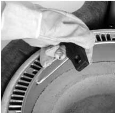
Fig. 8-12 Utilizzo della chiave per camera di combustione
