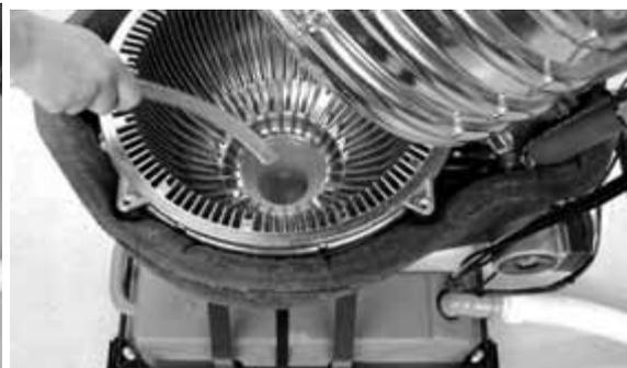
Fig. 3-9 Riempire di aria il tubo della condensa
