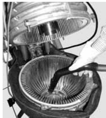
Fig. 8-14 Pulizia della camera di combustione
