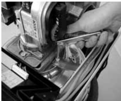
Fig. 5-8 Vite di fissaggio del supporto della canalina dei cavi
