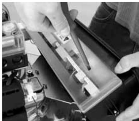
Fig. 5-5 Allentamento delle viti della copertura del quadro di comando
