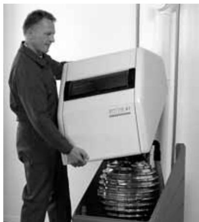
Fig. 8-1 Rimozione della cappa insonorizzante
