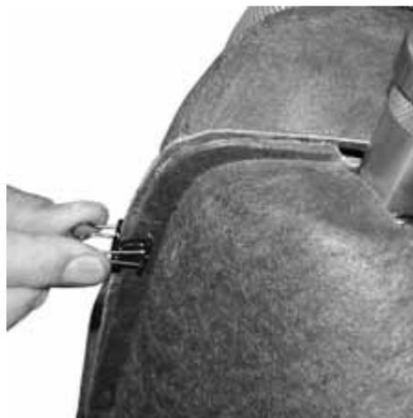
Fig. 8-2 Rimozione della clip di fissaggio dei gusci isolanti
