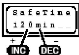
Contemporaneamente al processo di ricarica, si avvia automaticamente il Safe Timer incorporato. Esso deve evitare che in caso di un accumulatore difettoso o di un malfunzionamento della funzione di riconoscimento di completamento della carica, l'accumulatore collegato venga sovraccaricato.
