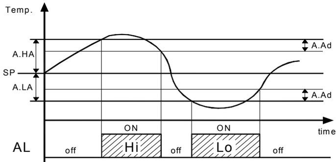
Gli allarmi di temperatura di massima e di minima possono essere disabilitati impostando i relativi parametri “**A.HA**” e “**A.LA**” = oF. L'intervento degli allarmi di temperatura prevede l'accensione del led **AL** di segnalazione allarmi, l'attivazione delle uscite configurate con funzione di allarme, l'attivazione del buzzer interno se configurato.
