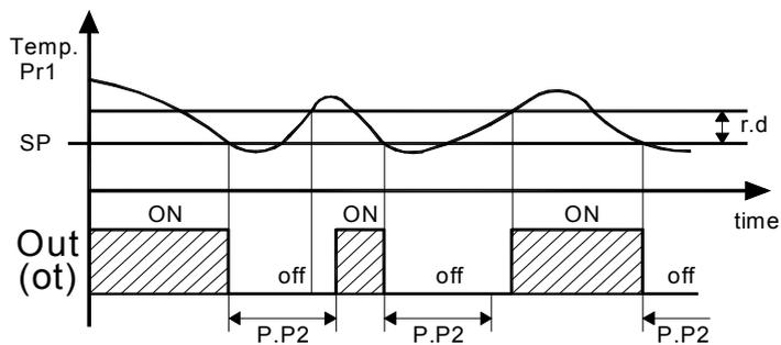
Il terzo controllo prevede un'inibizione all'attivazione dell'uscita "ot" se, da quando l'uscita è stata attivata l'ultima volta, non è trascorso il tempo impostato al parametro "P.P3" (ritardo tra le accensioni).
