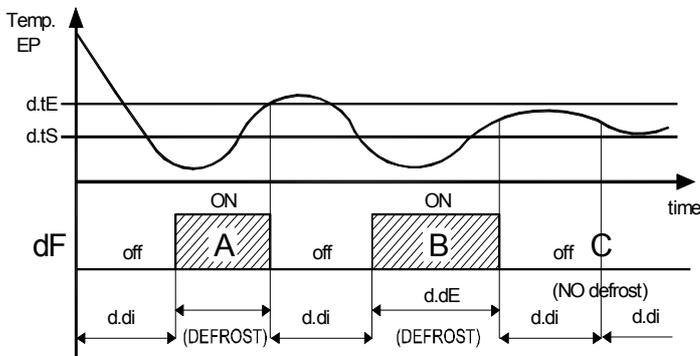
**Esempi di fine sbrinamento:** lo sbrinamento indicato come A termina per raggiungimento della temperatura "d.tE", lo sbrinamento B termina allo scadere del tempo "d.dE" in quanto la temperatura "d.tE" non viene raggiunta, lo sbrinamento C non avviene in quanto la temperatura è superiore a "d.tS".
