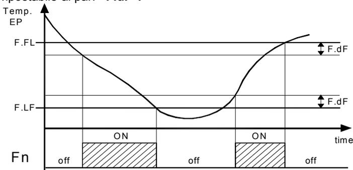
*Nota: Occorre prestare particolare attenzione all'utilizzo corretto delle funzioni di controllo delle ventole in base alla temperatura in quanto in una tipica applicazione di refrigerazione l'arresto delle ventole evaporatore blocca lo scambio termico.*
