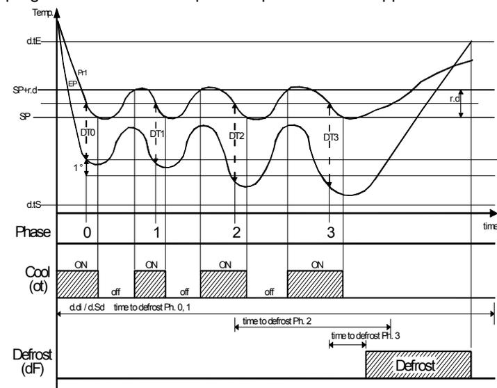
*esempio funzionamento "dynamic defrost intervals system" con riduzione "d.dd" = 40 % e fine sbrinamento per temperatura.*
