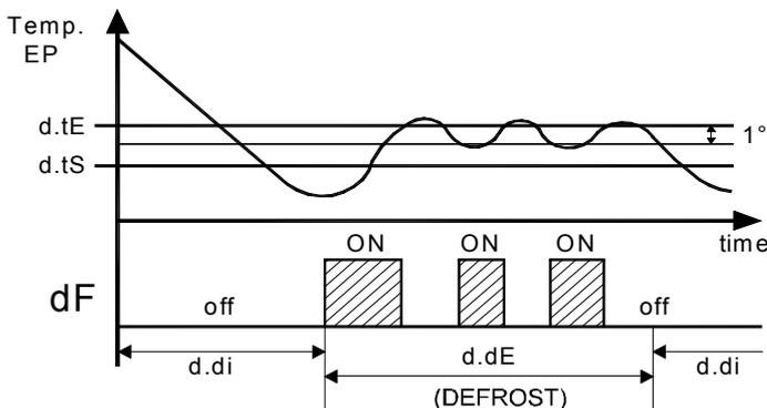
**Esempio di sbrinamento elettrico termostato:** lo sbrinamento termina allo scadere del tempo "d.dE". Durante lo sbrinamento l'uscita configurata come dF si accende/spegne come un regolatore di temperatura on-off in funzione di riscaldamento con isteresi di 1° allo scopo di mantenere costante la temperatura di sbrinamento al valore "d.tE" impostato.
