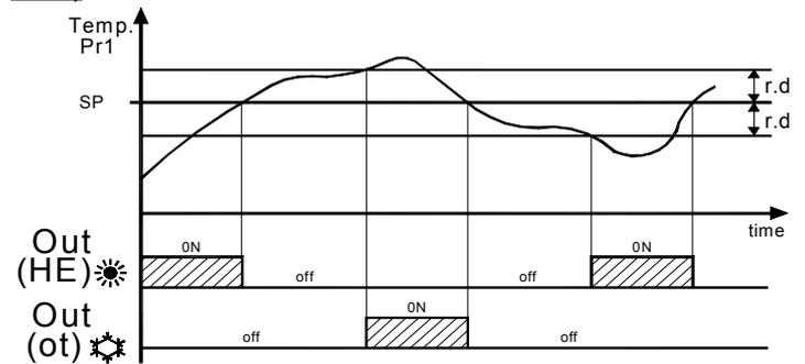
Nel caso in cui venga programmato il par. "r.HC" = nr l'uscita configurata come "ot" opera con azione di raffreddamento (come "r.HC" = C) mentre l'uscita configurata come "HE" opera con azione di riscaldamento.
