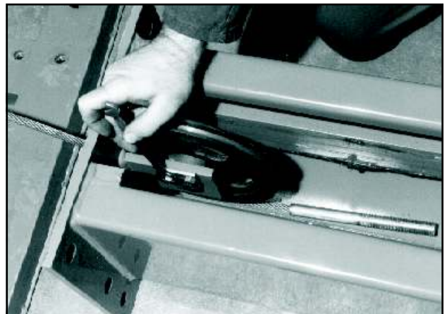
Fig.38 Smontaggio della puleggia Fig.38 Pulley demounting
