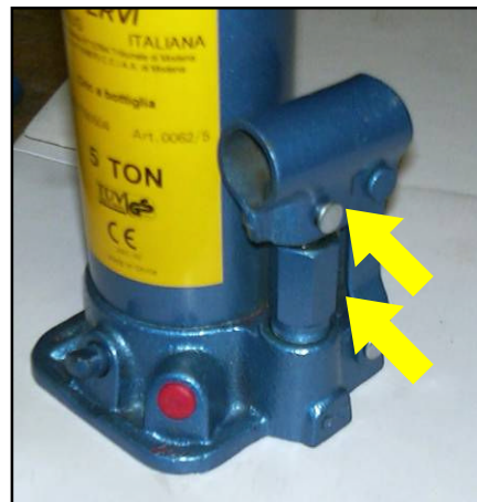
Figura 11 – Vite del punzone. Figura 12 – Perna e cerniere della pompa.
