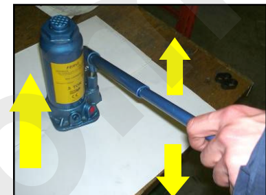
Figura 9 – Pompare per il sollevamento.
