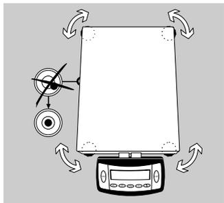
**Livellamento delle bilance con un campo di pesata superiore a 10 kg**
