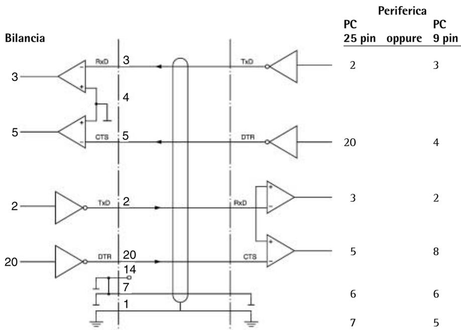
Tipo di cavo conforme a AWG 24
