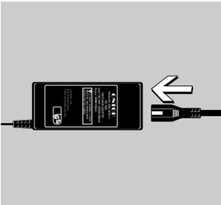
Inserire la linea di collegamento alla rete nell'alimentatore universale (per bilance con un campo di pesata fino 10 kg)
