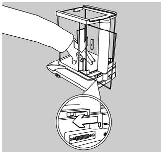
● Bloccare la camera di pesata con la leva posta sul retro della bilancia: spingere la leva verso sinistra esercitando una lieve pressione sulla base della camera di pesata
