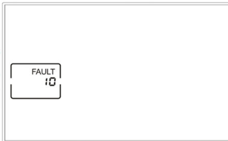
Fig. 6.8: Modalità di comunicazione guasto
