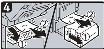
4. Se non è possibile rimuovere la carta inceppata, aprire il coperchio. Se la macchina dispone del vassoio a grande capacità, farlo scivolare a destra.
