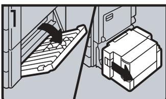
1. Aprire lo sportello destro dell'unità vassoio carta. Se la macchina dispone del vassoio a grande capacità, farlo scivolare a destra e aprire lo sportello destro dell'unità vassoio carta.
