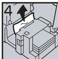
4. Se non è possibile rimuovere la carta inceppata, provare a rimuoverla dal lato sinistro del vassoio a grande capacità.
