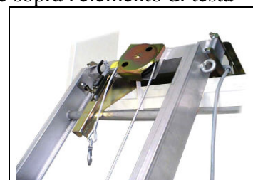
fig. 37 Condurre la fune sopra l'elemento di testa
