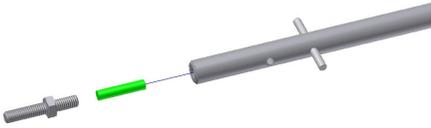
**IMPORTANT: THE TRACTION PIN SHOULD EQUALLY PROTRUDE FROM BOTH SIDES OF THE SHAFT.**
