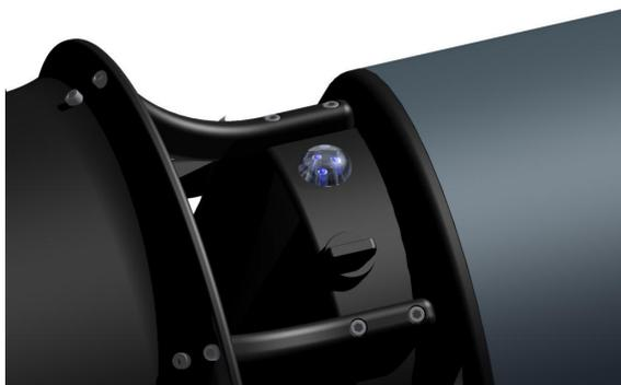
Sul corpo motore dell'ADV, è posizionato un segnalatore luminoso che indica lo stato di carica della batteria.
