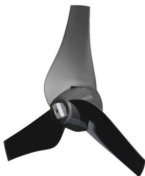
L'elica a facile sostituzione prop-lock, consente, senza l'ausilio di attrezzi, di estrarre l'elica dallo scooter subacqueo, in qualsiasi situazione; in caso di avvolgimento di corpi estranei, come cime o lenze da pesca o nel caso in cui si voglia sostituire l'elica con un'altra di forma o numero di pale diversa, sia in immersione che a terra.
