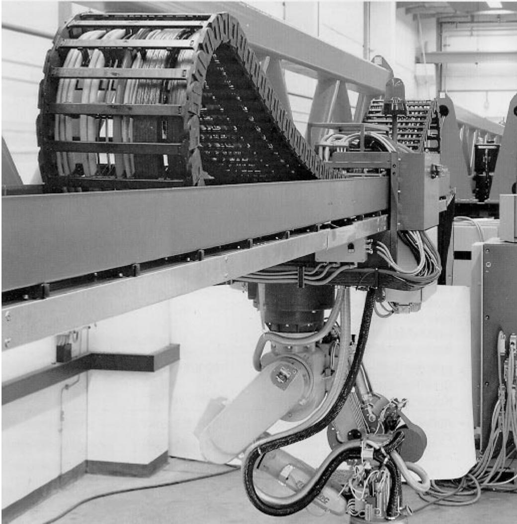
Figura 4. 5: Esempio di impiego di un cavo da trascinamento PROFIBUS in una catena portacavi
