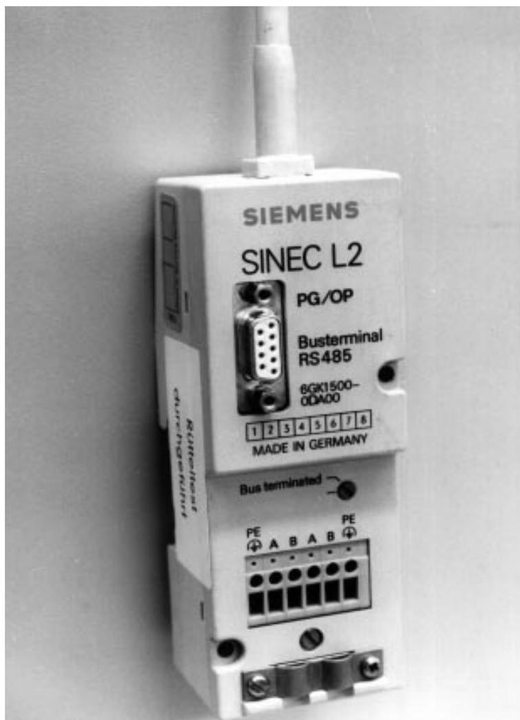
Figura 4. 9: Bus-terminal RS 485 con interfaccia PG
