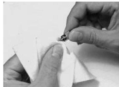
Pulire la superficie della fibra e il connettore con un panno inumidito con alcool.
