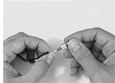
Spingere il capocorda a crimp sul corpo del connettore
