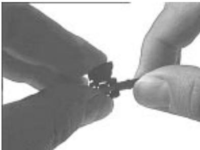
Fissare il conduttore simplex chiudendo e bloccando la parte posteriore del connettore (premere con forza le due metà del connettore fino a quando la parte superiore scatta nella parte inferiore).
