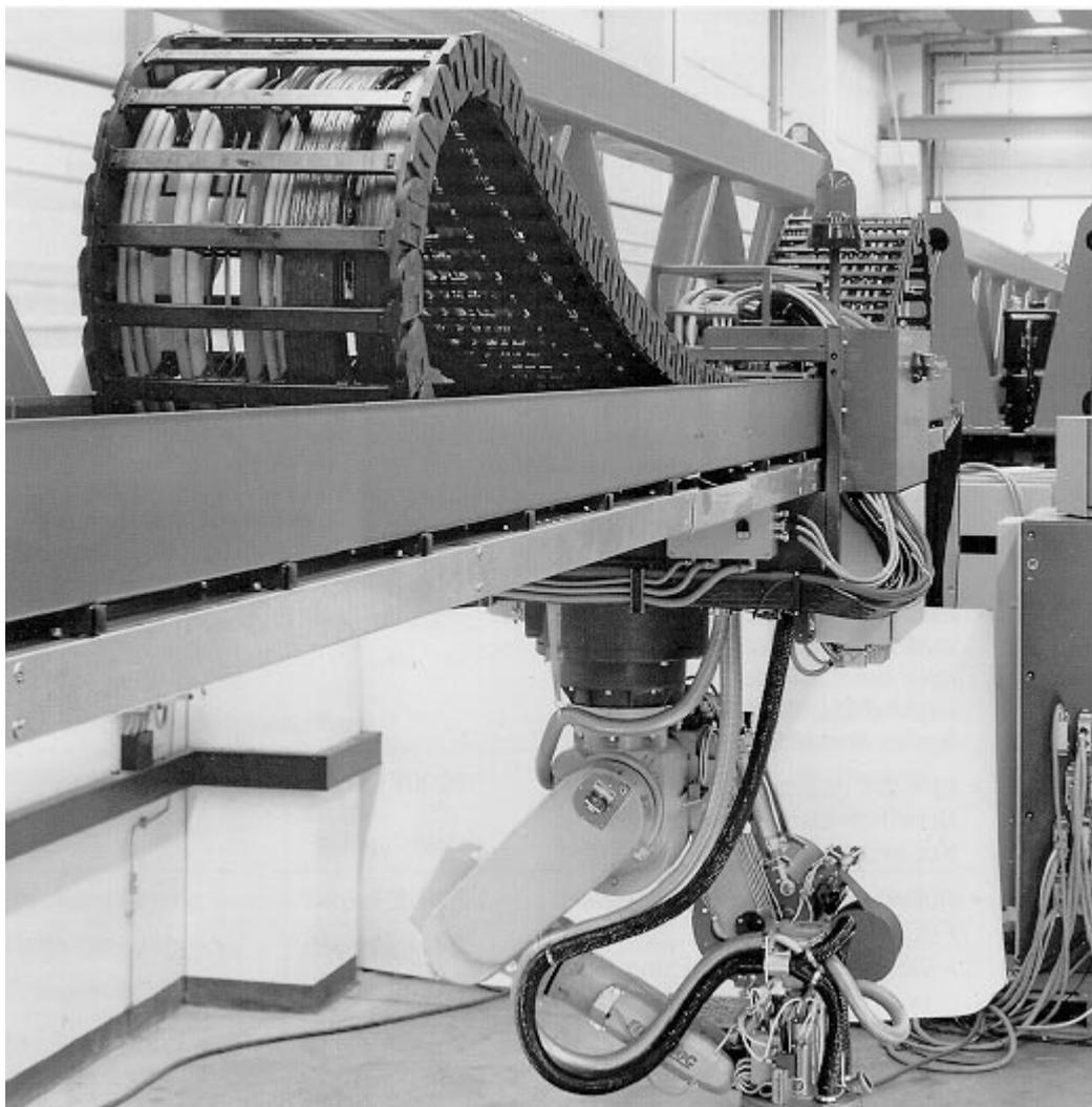
Figura 6. 5: Esempio di impiego del cavo LWL da trascinamento in fibra di vetro in una catena portacavi
