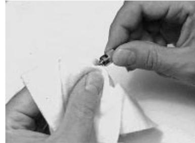
Eliminare i residui di fibra dalla superficie terminale della fibra e dal connettore utilizzando un panno inumidito con alcool.
