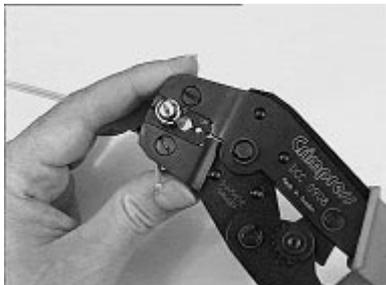
Unire il corpo del connettore al conduttore e al capocorda a crimp (ampiezza di crimpaggio 3,25 mm)
