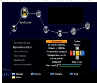
**Se avete un motore MOTEK, vi consigliamo di utilizzare il menu del posizionario anziché quello del DiSEqC 1.2. per assicurarsi che il vostro motore funzioni in modo corretto.**
