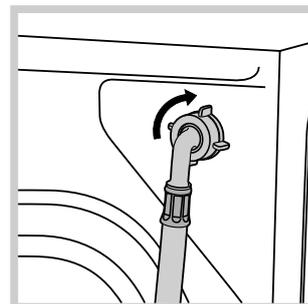
2. Conecte el tubo de alimentación a la lavadora enroscándolo en la toma de agua correspondiente ubicada en la parte posterior arriba y a la derecha (véase la figura).
