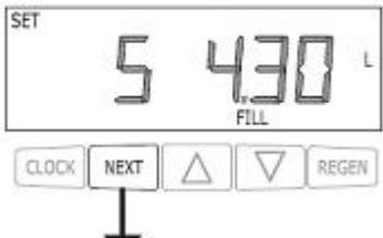
Par.7F - Inserire "Off" se non viene utilizzato il rigenerante (ad esempio solo il BACKWASH – lavaggio ) o accedere al volume di riempimento (in litri) usando i tasti ▼ o ▲. Premere NEXT (PROSSIMO) per andare al Par.8F. Premere REGEN per tornare al Par.precedente.
