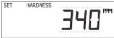
PAR.2I - Durezza: Impostare la quantità di durezza influente utilizzando i pulsanti ▼ o ▲. Questo display visualizza "-nA-" se "FILTRO" è stato selezionato nel Par.2f o se "-nA-" è stato selezionato in Par.5C se "OFF" o un numero è stato selezionato nel 9S Para.. Premere NEXT (PROSSIMO) per andare a 3I para. Premere REGEN per uscire dalle impostazioni di visualizzazione display dell'Installatore.
