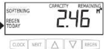
Per iniziare una rigenerazione MANUALE all'orario fissato per la rigenerazione ritardata, quando l'opzione del tempo di rigenerazione è impostata su "NORMAL" o "NORMAL + on 0", premere e rilasciare "REGEN".
