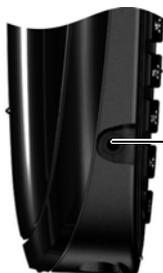
È possibile collegare, nell'apposita presa situata sul lato sinistro del portatile, un auricolare telefonico a filo dotato di spinotto jack da 2,5 mm come le cuffie Gigaset ZX300 o ZX400. Il volume della cuffia auricolare si regola come quello del ricevitore e le impostazioni si equivalgono.
