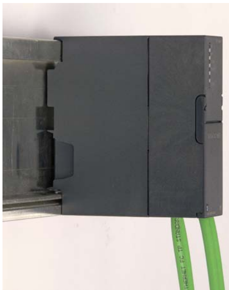
Figura 4-1 Montaggio del CSM 377 su una guida profilata SIMATIC S7-300
