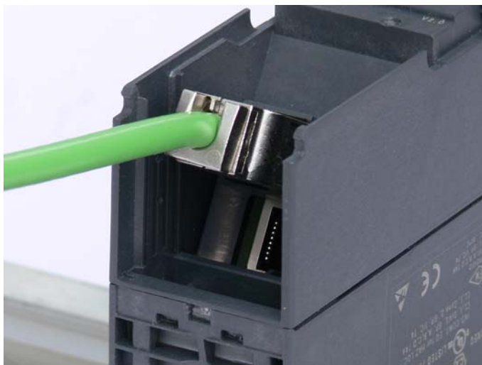
Figura 4-5 Innesto dell'IE FC RJ45 Plug 180
