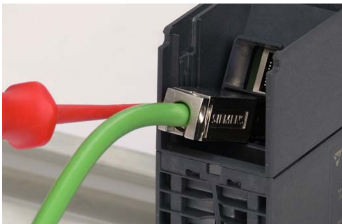
Figura 4-7 Smontaggio dell'IC FC RJ45 Plug sbloccando l' RJ45 Plug con l'aiuto di un cacciavite
