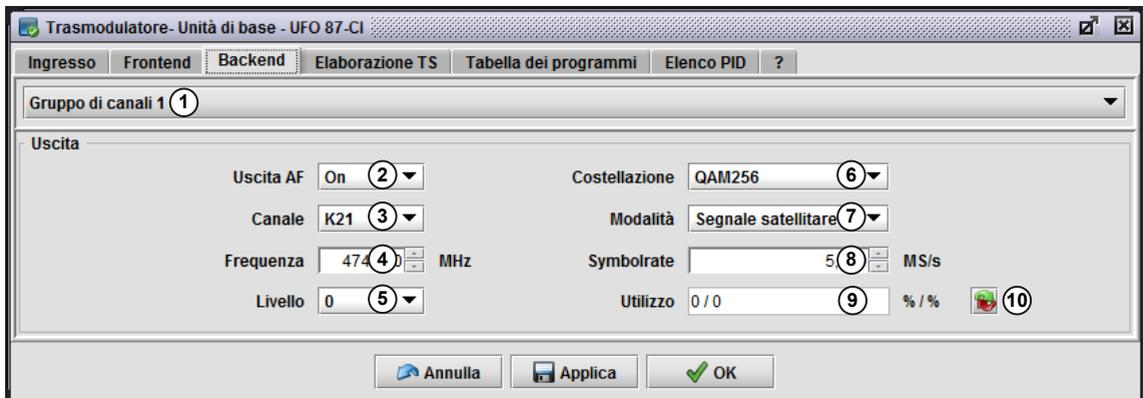
Fig. 33: Scheda **Backend** nella finestra di modifica del trasmodulatore
