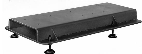
I basamenti destinati al montaggio cementato sono concepiti per utilizzare il cemento come elemento di rinforzo. I basamenti montati su sostegno sono invece realizzati per fornire la propria rigidità. Pertanto i modelli dei due basamenti sono perlopiù differenti.
