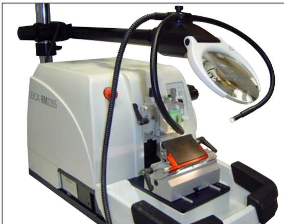
Figura 62, microtomo rotativo Leica con accessori opzionali montati: lente d'ingrandimento e conduttore a fibre ottiche
