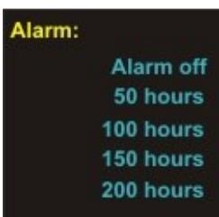
Casovač filtru - tato funkce umožňuje sledovat dobu použití filtrů počínaje nastavením její hodnoty. Prakticky využitelná např. při limitu použití pouze 50 hodin u filtrů pro rtuť..
