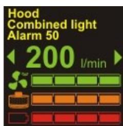
**Informační panel** – zobrazuje zvolený standard, typ používaného filtru, zbývající a nastavený čas, aktuální průtok, stav zanesení filtru a stav nabité akumulátoru.
