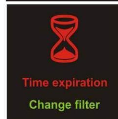
**La alarma** – Informa al usuario del tiempo de expiración del uso de los filtros. La alarma está también señalizada con un diodo LED de color rojo ubicada al lado de la pantalla.
