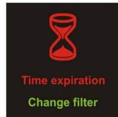
**Сигнальное устройство** – информирующее пользователя об истечении настроенного времени пользования фильтрами. Сигнальное устройство также даёт сигналы красным LED диодом, находящимся рядом с дисплеем.
