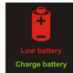
**Alarm** – informerar användaren om att batteriet är slut. Lämna det förorenade utrymmet och byt eller ladda batteriet.
