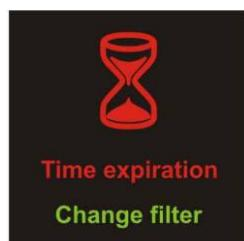
Alarm – Alarm, daß die eingestellte Filterstandzeit überschritten ist. Wird auch von einer roten LED neben dem Display angezeigt.
