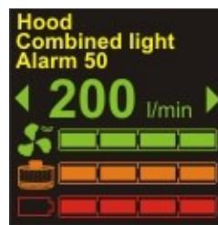
Display: visualizza la norma selezionata e il tipo di filtro in uso, il tempo rimanente e quello impostato per l'allarme, la portata d'aria attuale, lo stato di intasamento del filtro e di carica della batteria.
