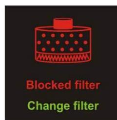
**Alarm** – informující uživatele o nedostatečném průtoku jednotky způsobeném zanesením filtrů. Je nezbytné opustit kontaminovaný prostor a vyměnit filtry.
