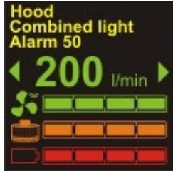
**Информационная панель** – изображает выбранный стандарт, тип применяемого фильтра, оставшееся и настроенное время, актуальную проточность, состояние засорения фильтра и состояние зарядки аккумулятора.
