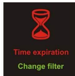
**Alarm** – informující uživatele o uplynutí nastaveného časového periody pro použití filtrů. Alarm je rovněž signalizován červenou LED diodou umístěnou vedle displeje.
