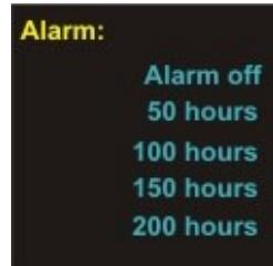
Einstellen der Filterstandzeit. Diese Funktion erlaubt Ihnen, die Filterstandzeit vom Moment des Auswechselns an zu überwachen. Ebenfalls sinnvoll für Filter, bei denen nur eine begrenzte Einsatzzeit erlaubt ist (z. B. 50 Stunden für Quecksilberfilter).
