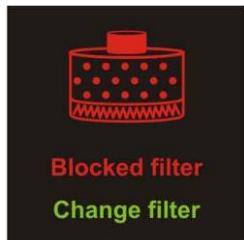
Alarm – Alarm wegen zu drigen Luftfluss aufgrund stoppter Filter. Die kontaminierte Umgebung muss sofort lassen und die Filter wechselt werden.
