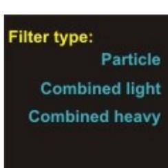
Momentan benutzter Filtertyp. Falls der falsche Filtertyp eingestellt ist funktioniert die Verstopfungskontrolle nicht korrekt.
