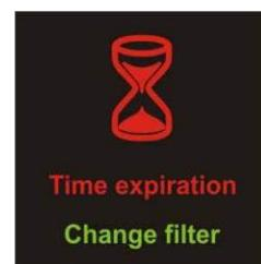
**Alarm** – informerar användaren om att den inställda tiden för användning av filtren har löpt ut. Alarmet signaleras även av en röd lysdiod bredvid displayen.
