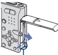
Fare scorrere la **leva di espulsione della batteria**.
