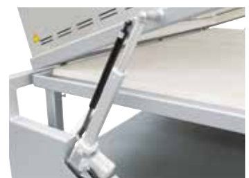
Apertura motorizzata della campana attraverso attuatore elettromeccanico a vite come dotazione aggiuntiva
