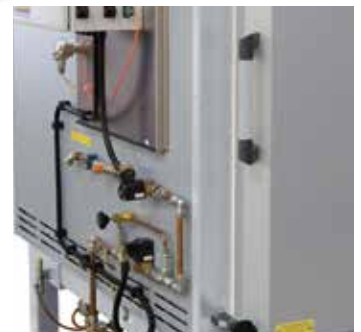
Percorso gas e termocoppia sul forno
