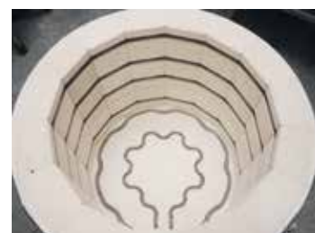
Riscaldamento del fondo come dotazione aggiuntiva
