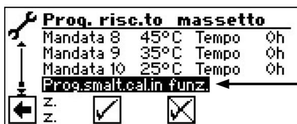
Dopo la partenza del programma di essiccazione del massetto, le temperature di mandata "M" impostate entrano in funzione una dopo l'altra.
