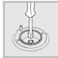
2. desensrosque los inyectores utilizando una llave tubular de 7 mm. (*ver la figura*), y sustitúyalos por otros que se adapten al nuevo tipo de gas (*ver la tabla "Características de los quemadores e inyectores"*);
