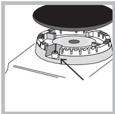
Si el aparato posee encendido electrónico\* (ver la figura), basta presionar y simultáneamente girar en sentido antihorario el mando del QUEMADOR hasta el símbolo de llama máxima y mantenerlo así hasta que se produzca el encendido. Puede suceder que, cuando se suelte el mando, el quemador se apague. En ese caso, repita la operación manteniendo presionado el mando durante un tiempo mayor.
