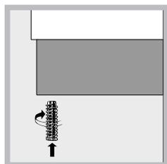
Se for necessário nivelar o aparelho, parafusar os pés de regulação fornecidos em dotação nos específicos lugares colocados nos cantos na base do fogão (*ver figura*).
