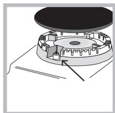
Se o aparelho for equipado com dispositivo de acendimento electrónico\* (*vide a figura*) será suficiente pressionar e contemporaneamente girar no sentido contrário ao dos ponteiros do relógio o selector QUEIMADOR no símbolo de chama mínima, até o acendimento. Pode ocorrer que
