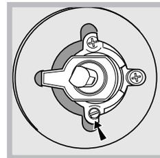
3. verificare che, ruotando rapidamente il rubinetto dalla posizione di massimo a quella di minimo, non si abbiano spegnimenti del bruciatore.
