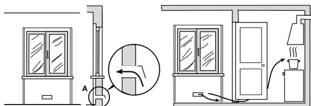
Abertura de ventilación para el aire comburente.
