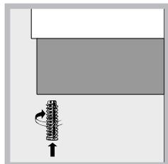
Si es necesario nivelar el aparato, enrosque las patas de regulación suministradas con el aparato, en los ángulos de la base de la cocina (*ver la figura*).
