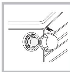
1. Após ter desligado o forno da electricidade, remova a tampa de vidro do porta-lâmpadas (*ver figura*).
