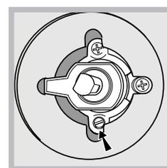
3. verifique em seguida se ao girar rapidamente a torneira da posição de máximo até a de mínimo, o queimador não se apague;
