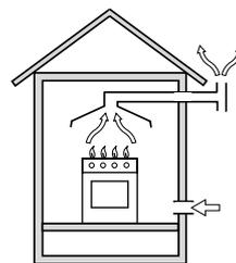
Descarga mediante chimenea o conducto de humos ramificado (reservado a los aparatos de cocción)
