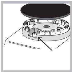
Se l'apparecchio è dotato di accensione elettronica\* (vedi figura) è sufficiente premere e contemporaneamente ruotare in senso antiorario la manopola BRUCIATORE sul simbolo di fiamma massima, fino ad accensione avvenuta. Può
