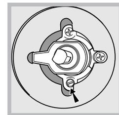
3. compruebe que, al girar rápidamente la llave de la posición de máximo a la de mínimo, no se apague la llama.
