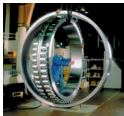
Montaggio di un grande cuscinetto
