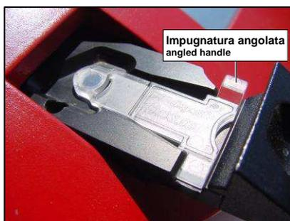
Fig. 15 - Cuvetta correttamente inserita
