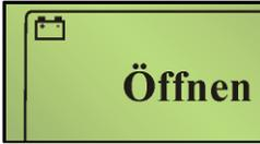
L'utilizzo con powerbox viene visualizzato sul display mediante il simbolo a sinistra.
