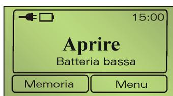
Il simbolo della batteria indica la capacità residua. Avviso batteria in caso di capacità insufficiente. Ricaricare con urgenza.
