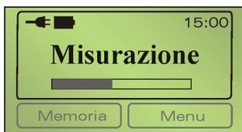
Chiudendo l'alloggiamento della cuvetta si avvia la misurazione.
