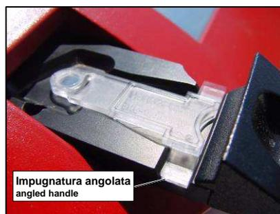
Fig. 16 - Cuvetta erroneamente inserita
