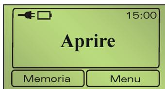
Il simbolo della spina indica l'alimentazione di rete. L'ulteriore freccia nel simbolo della batteria indica la ricarica.
