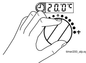
Dopo circa 5 secondi il display smetterà di lampeggiare e tornerà a visualizzare il valore della temperatura in cella.
