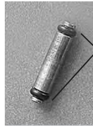
Il cilindretto con gli oring di tenuta del manometro
