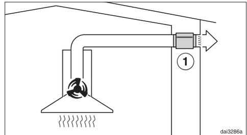
L'insonorizzatore riduce i rumori del ventilatore verso l'esterno e anche i rumori esterni che entrano in cucina attraverso il tubo di evacuazione (ad es. rumori del traffico). L'insonorizzatore va installato possibilmente in prossimità dell'uscita di sfiato ①.
