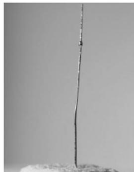
Se il **filo d'argento** si è **fuso** completamente o quasi completamente, la temperatura dell'unità è **troppo elevata**.
