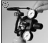
l'aide de l'écrou-raccord. Serrer l'écrou-raccord à l'aide d'une clé de 30. ② Vérifiez la mise en place du joint et la propreté des portées de joint !
