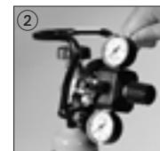
**2. Het terugslagventiel in de CO<sub>2</sub>-slang plaatsen**
