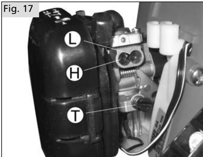
Il carburatore è dotato di 3 viti di regolazione:
