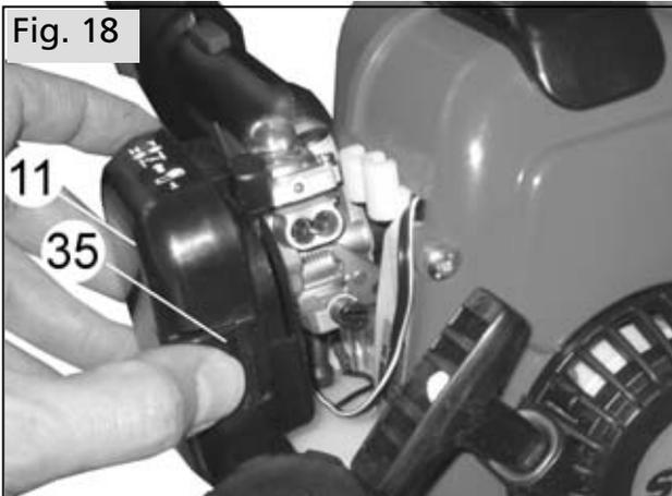
Prima di aprire il filtro dell'aria chiudere la farfalla dello starter
