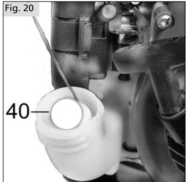
Il filtro del carburante può essere estratto con molta attenzione da un operaio specializzato con l'ausilio di un filo con cappio attraverso l'apertura del serbatoio. È necessario fare attenzione che la guarnizione del tubicino del carburante non caschi all'interno del serbatoio.
