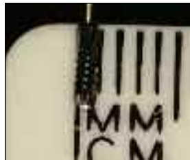
Midwest 1558-Bohrer mit einem Durchmesser von 1,0 mm
