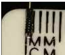
Fresa Midwest 1558 con diametro di 1,0 mm
