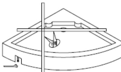
**Fase 3: Installazione del pannello posteriore.** Usare le viti M6x25 per fissare il pannello posteriore al pannello doccia e al piatto.
