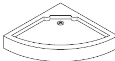
**Fase 2: Regolazione livello.** Appoggiare la livella sul piatto, controllare e sistemare i piedini fino a che tutto sia piano, poi usare una chiave inglese per fissare il dado.
