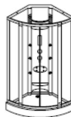
**Fase 6: Installazione del tetto.** Appoggiare il tetto sopra la cabina. Sistemarlo bene, poi usare viti M4x16 per fissare il tetto con il pannello posteriore e la struttura in vetro
