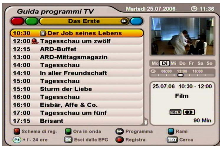
Nella visualizzazione anteprima si vedono tutte le trasmissioni del programma selezionato in precedenza nella visualizzazione «Ora in onda». Se l'emittente dei programmi trasmette i dati EPG, il ricevitore visualizzerà le trasmissioni del programma selezionato fino a diversi giorni in anticipo.
