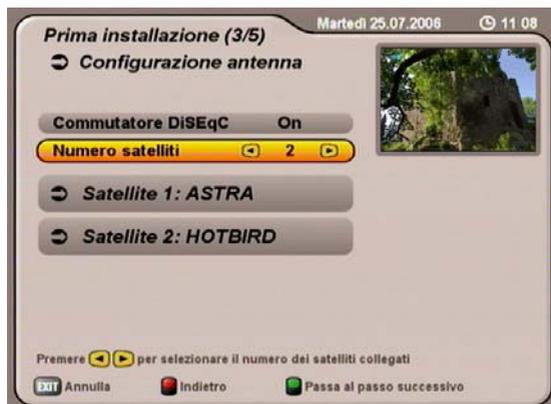
Selezionare con i tasti **◀ ▶** quanti satelliti (max. 4) può ricevere l'impianto di ricezione. Viene visualizzata la seguente sovrapposizione (esempio):
