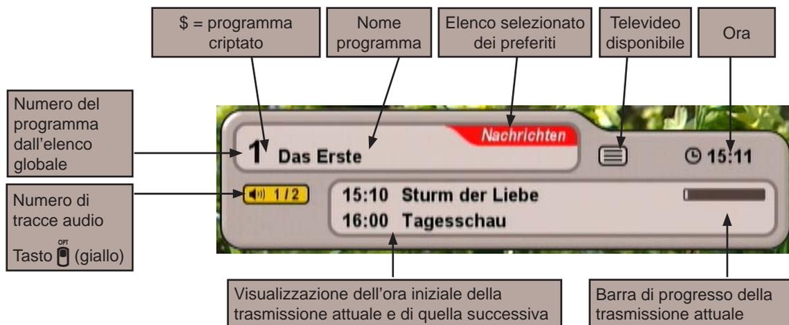
La segnalazione del programma viene sovrimpressa per alcuni secondi ad ogni cambio di programma (può essere regolata nel menu «Impostazioni», «Adatta sovrimpressioni») o in continuo con il tasto **i**.
