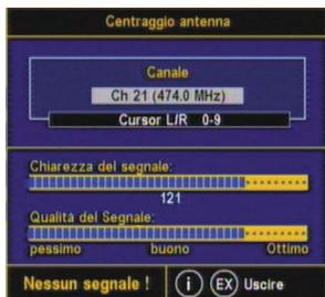
Il punto «E.» o «F.» sul display a 7 segmenti dell'apparecchio indica che il sintonizzatore si trova nel modo reticolare e che viene ricevuto un segnale digitale - in tal modo è possibile centrare l'antenna in un punto esposto solo con l'ausilio del display a 7 segmenti dell'apparecchio, cioè anche senza televisore con la sovrimpressioni del menu.
