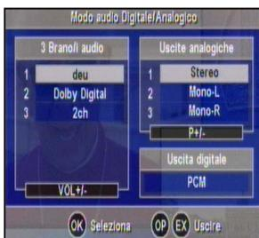
Nella finestra destra viene visualizzato l'attuale stato di segnale sulle uscite digitali (= presa RCA digitale è l'uscita digitale ottica).
