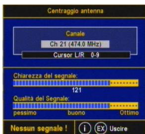
Nel sottomenu «Centraggio dell'antenna» si può richiamare il menu conosciuto nella prima installazione e visualizzare quindi l'intensità di campo nonché la qualità di ricezione per il canale desiderato (selezione tramite i tasti numerici oppure i tasti **◀▶**).
