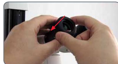
2. Nel caso in cui l'oculare sia dotato di correzione diottrica integrata, ruotare il valore sulla marcatura "0".
