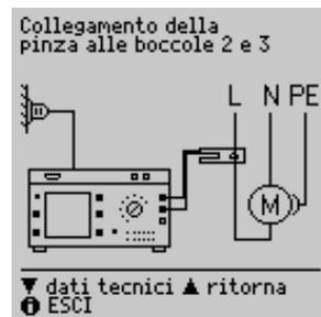
Tramite un trasformatore corrente/tensione a pinza (p. es. WZ12C) collegato alle boccole 2 e 3 si possono misurare correnti alternate in due campi di misura (1 mA ... 10 A ~, 1 A ... 100 A~).
