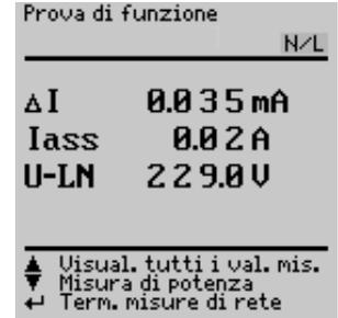
Con il tasto (14) è possibile togliere la tensione alla presa di prova; con il tasto (12) si termina la prova di funzione.
