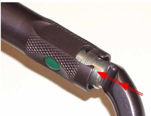
Spingere il fermo elastico completamente nell'apertura
