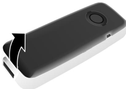
Per **rimuovere la batteria** inserire un'unghia nella fessura sotto la batteria e sollevare il pacchetto batterie verso l'alto.
